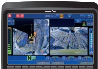
Con KomVision, varie opzioni di configurazione delle viste offerte dalle telecamere aiutano ad avere una visibilità totale costante dall'alto della macchina
