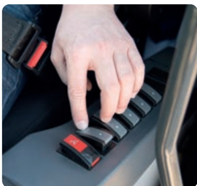
Pulsanti progettati ergonomicamente che si accendono per un utilizzo notturno facile e sicuro
