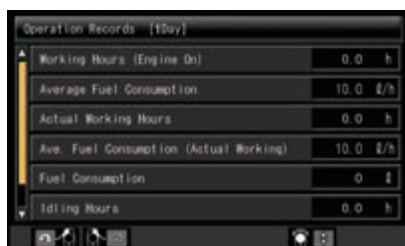
Un monitor multifunzione visualizza e gestisce una grande quantità di dati operativi e di manutenzione
