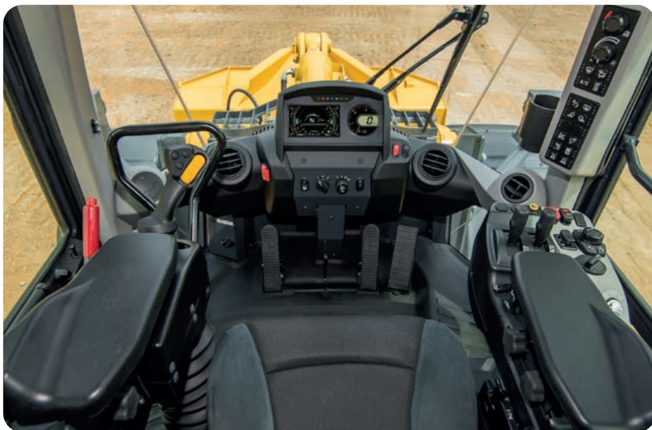
L'immagine mostra il sistema sterzante Advanced Joystick Steering System (AJSS) (optional)
