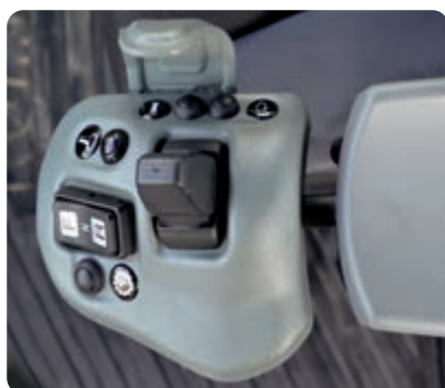
Leva corta di sterzo – Komatsu (K-SLS) (optional)
