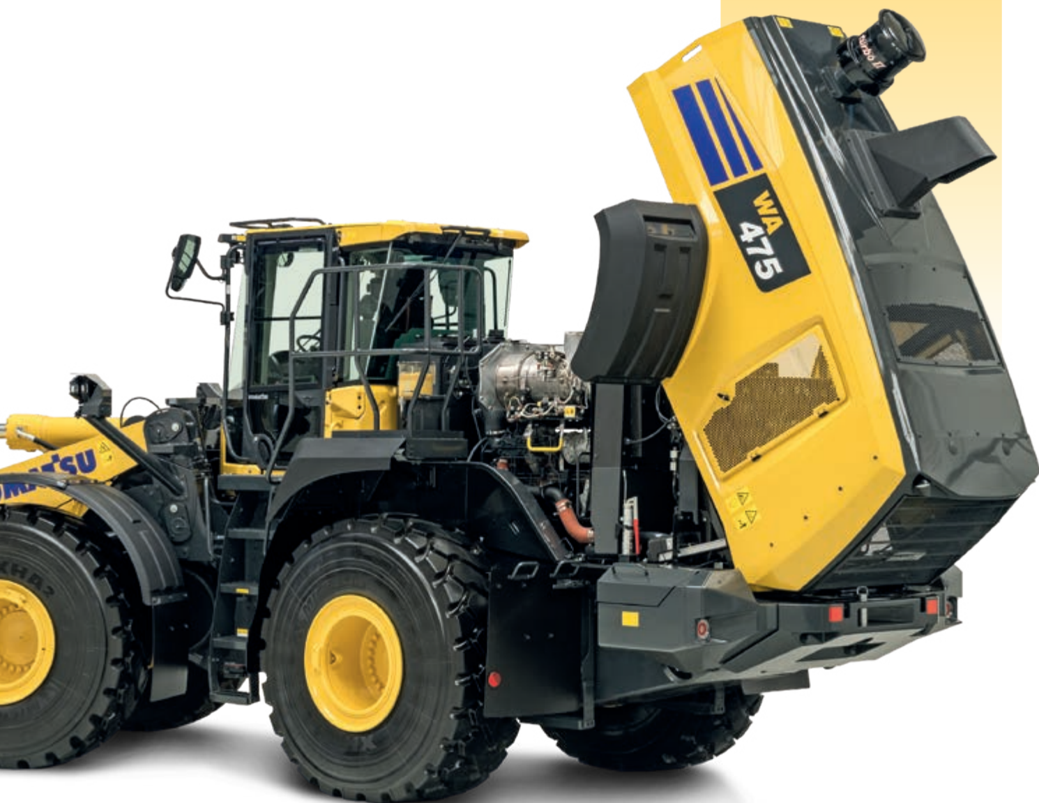
Gli sportelli ben posizionati garantiscono un accesso agevole e sicuro ai punti di manutenzione giornaliera
