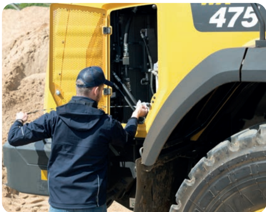
Gli sportelli ben posizionati garantiscono un accesso agevole e sicuro ai punti di manutenzione giornaliera
